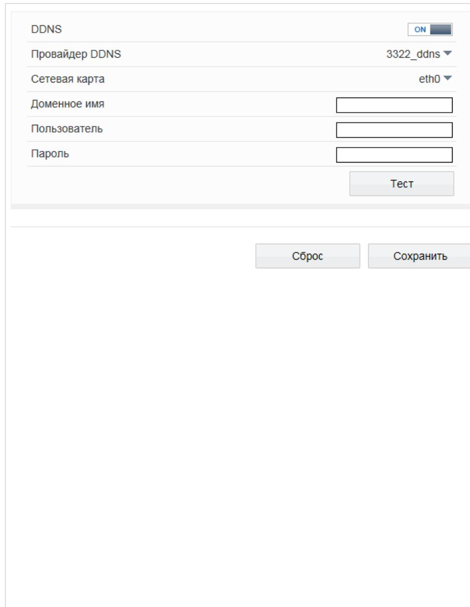
Динамическая служба доменных имен DDNS обеспечивает назначение постоянного доменного имени (например, <http://camera.dyndns.org>) камере с динамическим IP-адресом. Это позволяет производить подключение к камере по одному и тому же «простому» адресу, даже при изменении IP-адреса камеры. Служба DDNS автоматически сопоставляет новый адрес устройства с присвоенным ему доменным именем.
