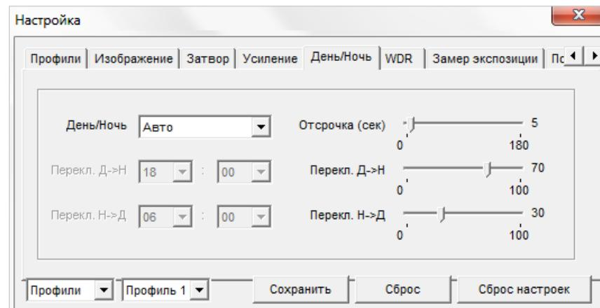
В зависимости от уровня освещенности камера может работать в цветном или черно-белом режимах. При работе в цветном режиме ИК-фильтр отсекает часть светового излучения, корректируя цветопередачу. При переходе в черно-белый режим ИК-фильтр убирается для увеличения чувствительности.
