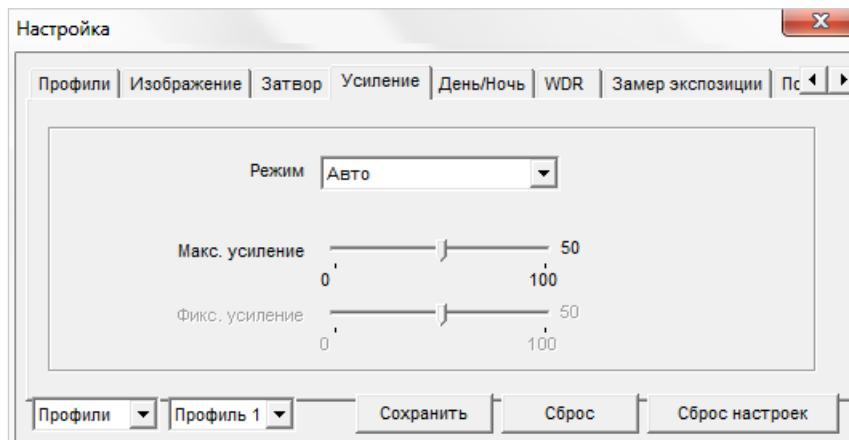
**Авто** – автоматическая регулировка усиления в зависимости от уровня освещенности
