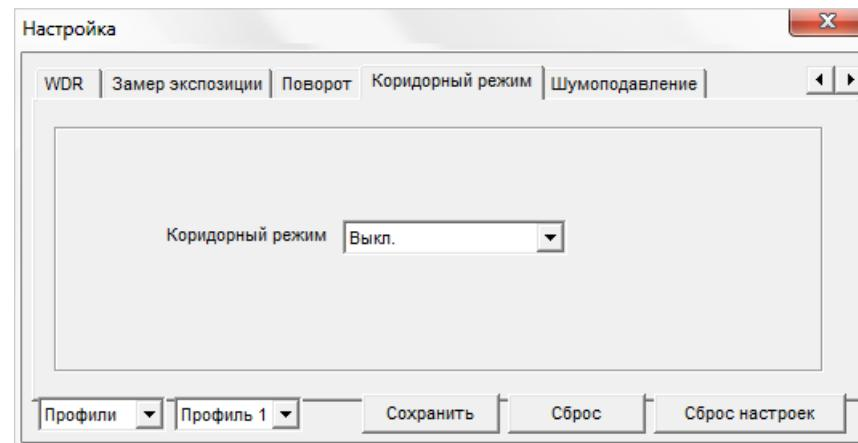
Коридорный режим позволяет изменить ориентацию изображения на вертикальную и за счет этого более рационально контролировать узкие пространства, для которых в стандартном режиме значительную часть кадра занимают неинформативные боковые области. Примерами таких пространств являются коридоры, проходы и лестничные пролеты.
