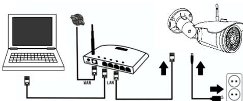
Схема подключения IP-камеры.
