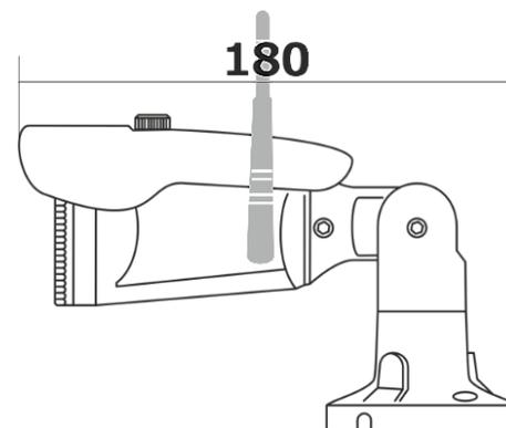
*\*Общий вид камеры может отличаться от приведённого в зависимости от применяемого объектива и модификации корпуса. Все размеры в мм.*
