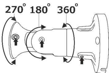
**ВНИМАНИЕ!** При монтаже камеры не допускайте многократный поворот (более 360°) корпуса камеры относительно продольной оси кронштейна, т. к. это приведет к скручиванию и разрыву провода питания/сигнального.
