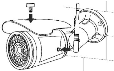
► Извлеките из упаковки и установите на камеру солнцезащитный козырек, зафиксировав его винтом из комплекта.
